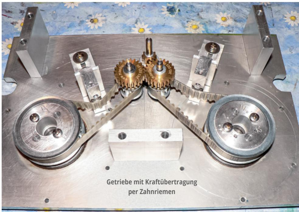
Getriebe mit Kraftübertragung per Zahnriemen
